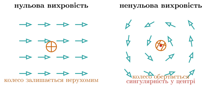
Рисунок 3: Ліворуч: однорідний потік має нульовий ротор — лопатеве колесо, розміщене будь-де, залишається нерухомим. Праворуч: вихор має ненульовий ротор — лопатеве колесо обертається. Ротор вимірює локальне обертання рідини.
